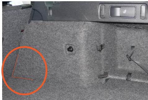
VALSE BODEM GEPLAATST EN OP HET HOOGSTE NIVEAU
