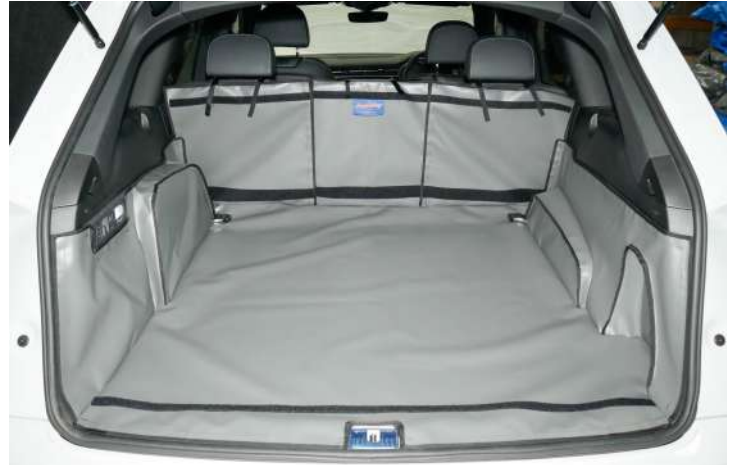
Gesplitste achterklepbeschermer, voorbereid voor stoel flap, bumper flap & bodemverlenging
