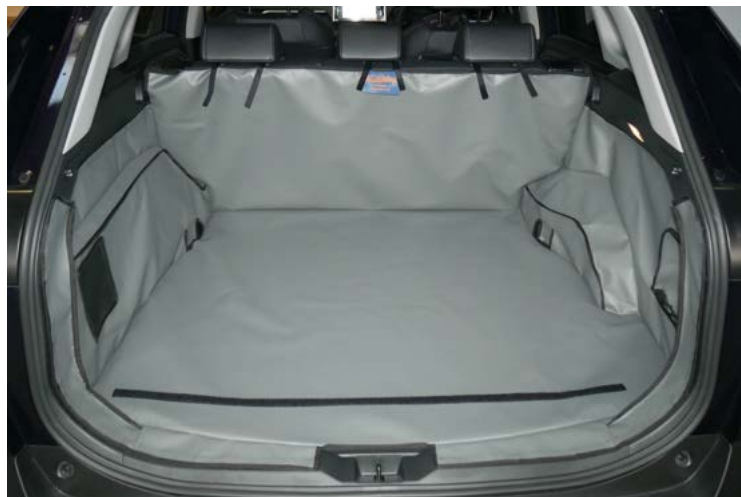
Vorm 1, met gaas over speaker, d-ring opening en bevestiging voor bumper flap.
